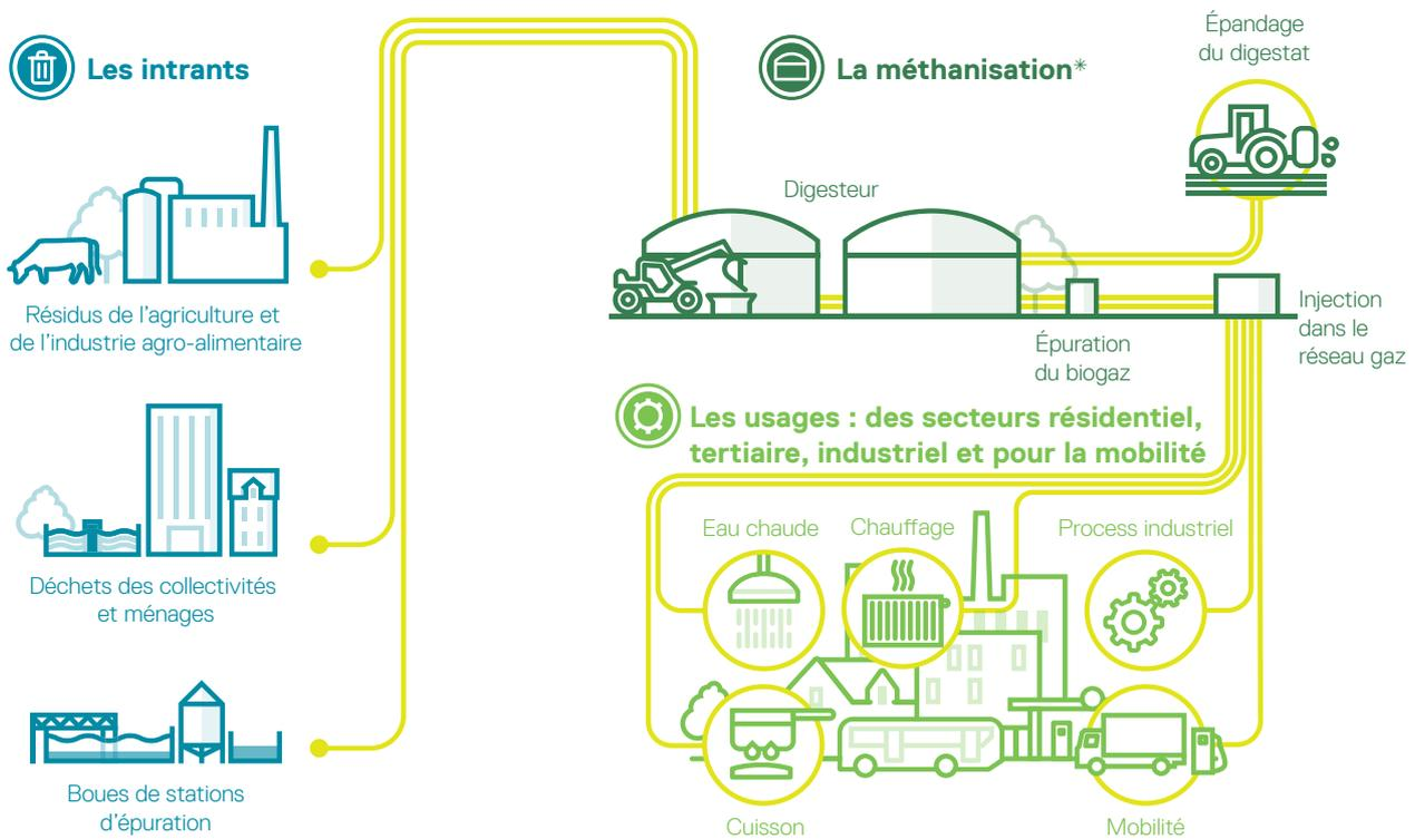
\* Dégradation de la partie fermentescible des intrants, en l'absence d'oxygène, pour produire du biogaz.
