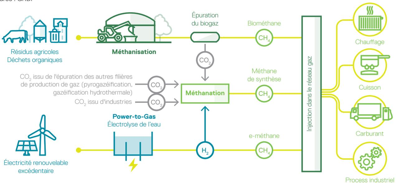
Le **power to méthane** consiste à produire du méthane de synthèse, ou « e-méthane », par une combinaison de deux étapes : d'abord, l'électrolyse de l'eau (également appelée « power-to-gas ») pour obtenir de l'hydrogène, puis la méthanation, qui permet de combiner cet hydrogène avec du CO<sub>2</sub>. Ce CO<sub>2</sub> peut provenir de l'épuration de biogaz (bioCO<sub>2</sub>) ou être capté dans des fumées industrielles (CO<sub>2</sub> fatal issu de processus industriels ou de combustion).
